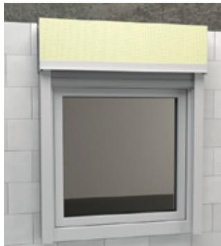
Der Aufsatzrollladenkasten ist mit einer Außenblende versehen. An der unteren Aluminiumabschlusschiene befindet sich ein Dichtungsprofil, welches den Panzer-auslassschlitz verringert und damit die Zugluft im Rollraum minimiert.
