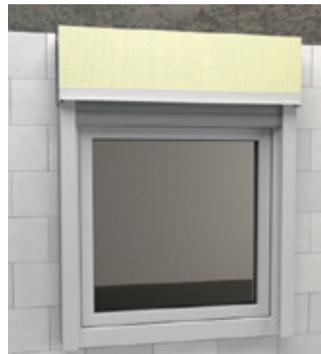
Der Aufsatzrolladenkasten ist mit einer Außenblende versehen. An der unteren Aluminiumabschlusschiene befindet sich ein Dichtungsprofil, welches den Panzer-auslassschlitz verringert und damit die Zugluft im Rollraum minimiert.
