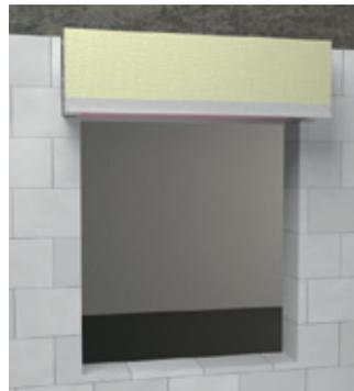
Der Fertigrolladenkasten ist mit einer Außenblende versehen. An der unteren Aluminiumabschlussschiene befindet sich ein Dichtungsprofil, welches den Panzer-auslassschlitz verringert und damit die Zugluft im Rollraum minimiert.
