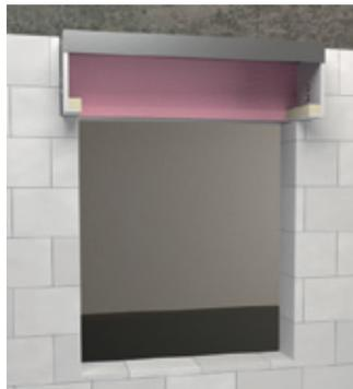
Der Fertigrolladenkasten hat an der Rückseite ein Aluminiumprofil als Anschlag für das Verblendmauerwerk.
